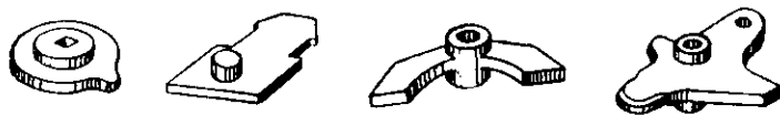
Rys. 263. Przedmioty z jednostronnymi i dwustronnymi występami wykonywane za pomocą spęczania na zimno
